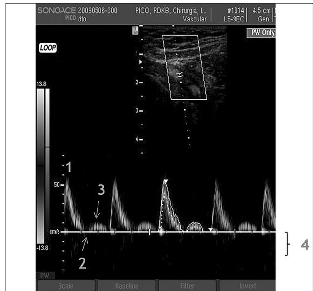
**Рис. 2.** Спектрограмма *a. iliaca externa* при дисплазии тазобедренных суставов: 1 — систолический зубец, 2 — ранний диастолический зубец, 3 — фаза диастолы, 4 — спектральное «окно — зона» (отсутствует)
