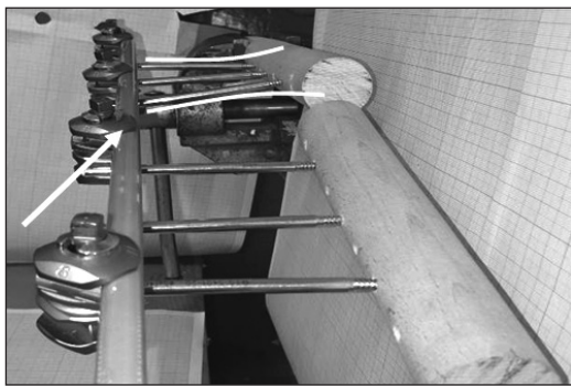
Рис. 7. Загальний вигляд деформованої конструкції «уламки – ЗСА» із демонстрацією з'єднувального вузла та стрижня, в яких відбувається залишкова деформація
