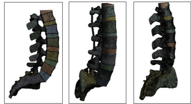
Рис. 3. Скінченно-елементна модель розрахункової схеми 1.11
