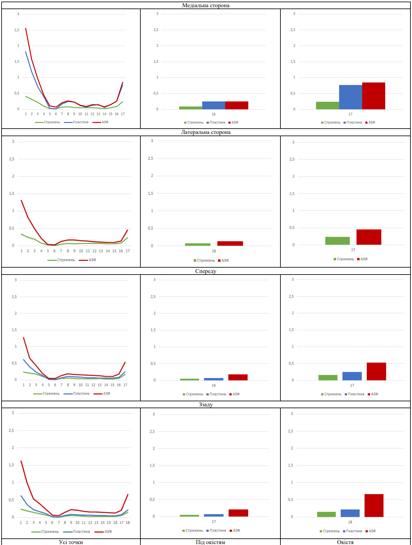
Рис. 4. Діаграми рівня напружень (МПа) у контрольних точках фібрин-кров'яного згустку й окістя за різних способів з'єднання відламків у разі дії на сегмент осевого навантаження 800 Н
