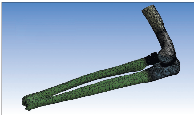
Рис. 1. Модель локтевого сустава с эндопротезом KPS в положении максимальной пронации с углом сгибания 90°
